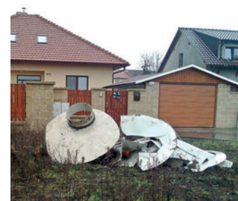
Obr. 3: Monolitická nádrž na vodu AS-MONA (nahore) a zhavarovaná nádrž – nesamonosná (dole)
