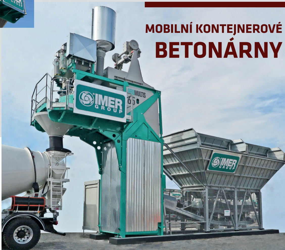
Betonárna ORU MULTIS 55 s planetovou míchačkou MS 1500/1000 – 1 m 3
