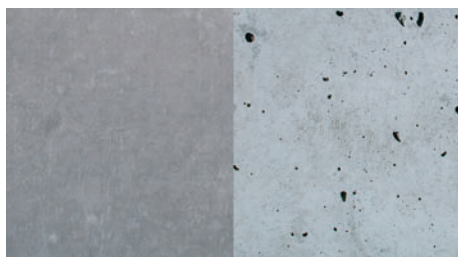
Difuze chloridu 28 dní, 16% NaCl, 40°C
