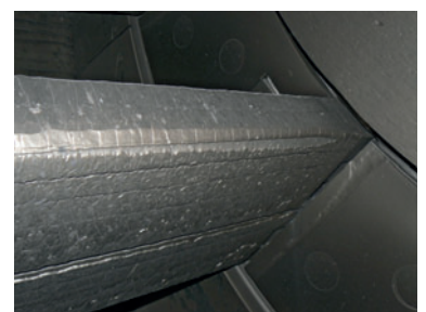
Mlecí deska – skutečnost po 1230 hod provozu
