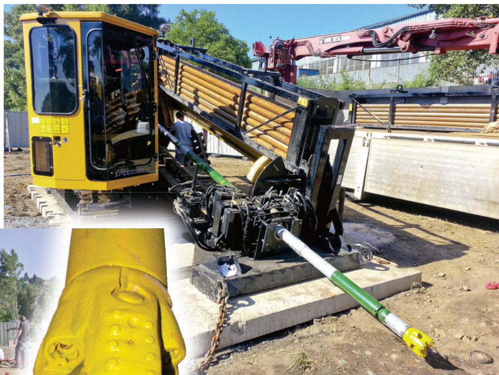
Vermeer Navigator D80x100 serie II s vrtací hlaví Mud Motor pro vrtání skalních podloží
